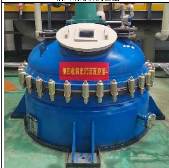
银回收氯化沉淀反应釜 2#
